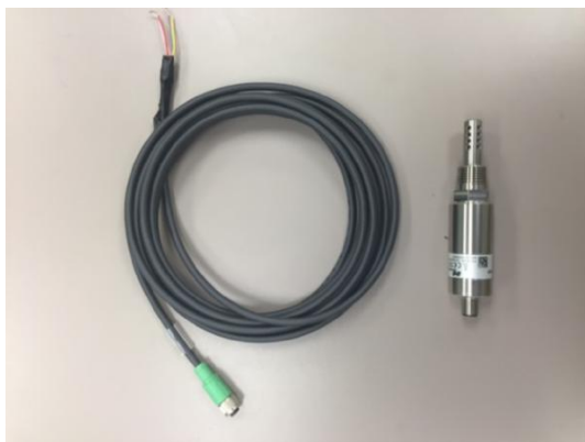
Рисунок 15 Е + Е Влагозащитный индикатор Рисунок 16 Е + Е Установленный зонд
