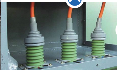
安装在电动机接线盒中的 环氧云母电容器
