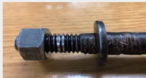
图3： 故障螺栓/螺 母组件的照片 显示螺纹 已损坏
